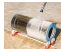
Spin Filter, nettoyage des cartouches
